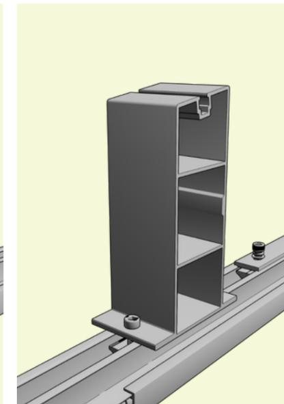
4) Schieben Sie anschließend den vorderen Standfuß durch die Schiene an die richtige Position und befestigen anschließend die M8\*25 Schraube. Wiederholen Sie den Schritt mit allen Standfüßen vorne.
