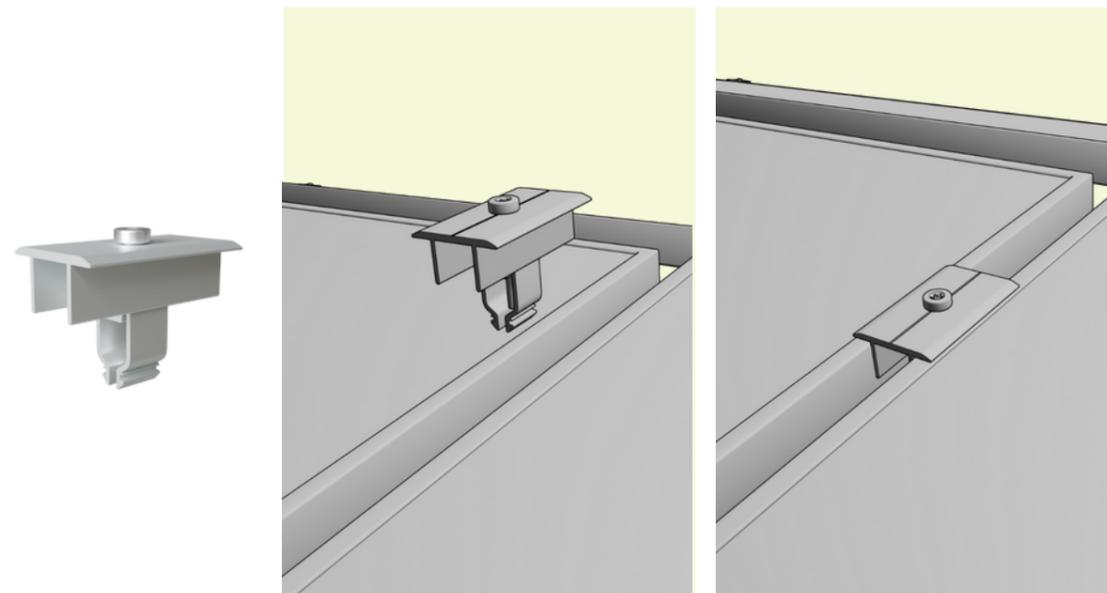
8) Für die hintere Stütze müssen Sie das untere Teil der Klemme um 90° drehen. Danach können Sie diese an der hinteren Stütze anbringen und befestigen.
