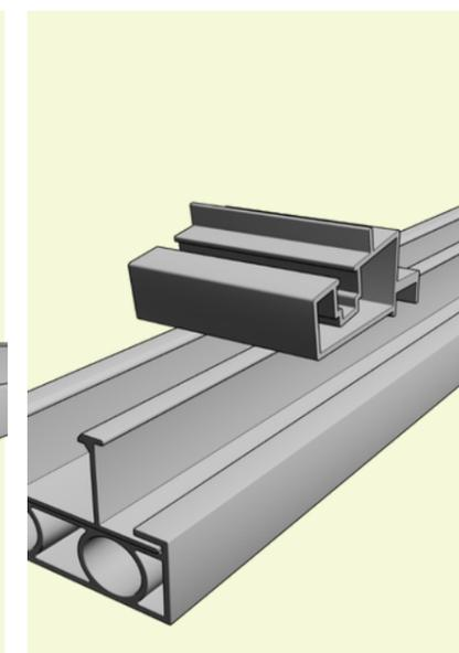
5) So sollte Ihre Konstruktion nun Aussehen. Stellen Sie sicher, dass die Schienen auf einer Höhe liegen. Legen Sie die Ballastplatten auf die Schienen und befestigen diese mit Betonblöcken oder Sandsäcken.
