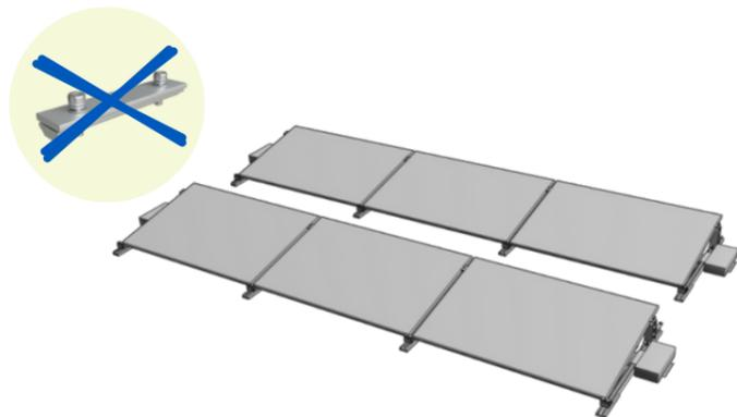
**!** Die Reihenfolge der nächsten beiden Schritte ist von Ihrer gewünschten Ausrichtung abhängig. Für eine Ost/West Ausrichtung folgen Sie der Anleitung, für eine Süd-Süd Ausrichtung beachten Sie die unterschiedliche Platzierung der Stützen in der Mitte, ebenso wie die der Klemmen.
