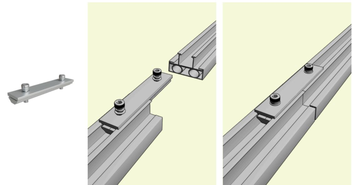
2) Platzieren Sie die verbundenen Basisschienen an der gewünschten Stelle. Der Abstand der Schienen zueinander lässt sich ungefähr so ausrechnen: *Breite Solarmodul - ca 7cm*
